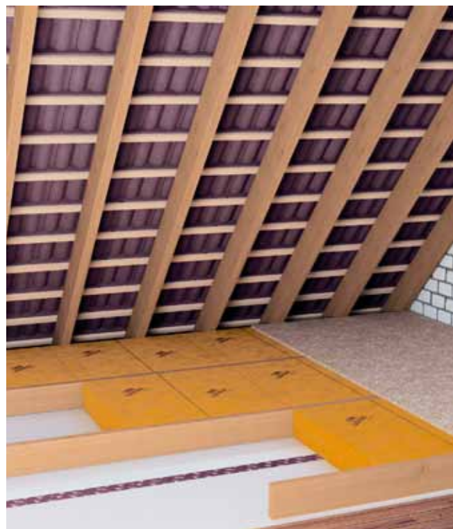
Izolacja poddasza nieużytkowego z użyciem płyt z wełny mineralnej szklanej
