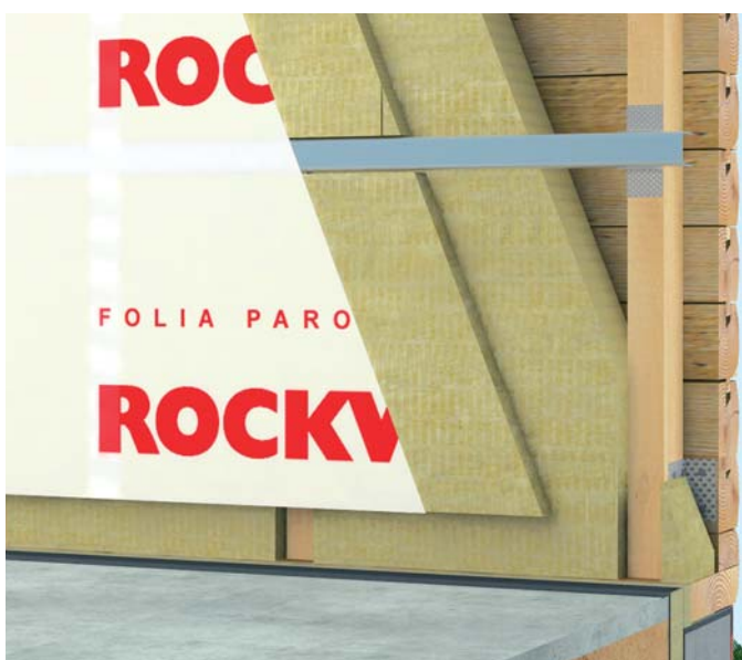
WIZ. 126.5. Ułożenie paroizolacji.
