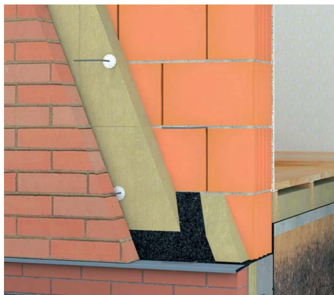
WIZ. 121.4. Wymurowanie warstwy osłonowej z klinkieru.
