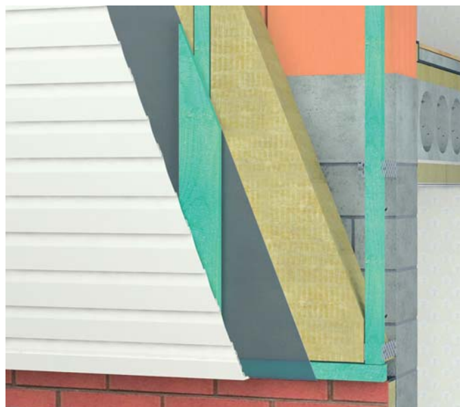
WIZ. 123.4. Nabicie do rusztu paneli elewacyjnych, np. z sidingu.
