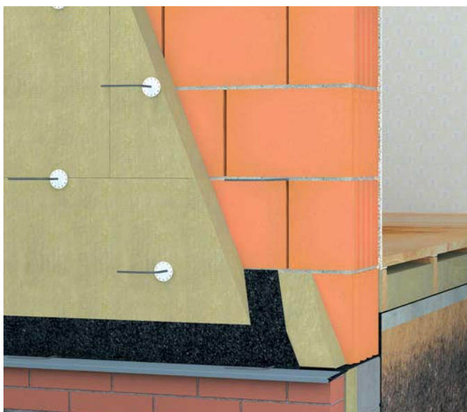
WIZ. 121.3. Założenie wełny na kotwy i dociśnięcie talerzykiem dociskowym.
