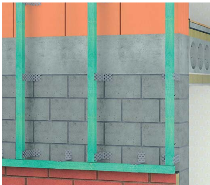
WIZ. 123.1. Mocowanie drewnianego rusztu do ściany za pomocą azurowych wieszaków metalowych.
