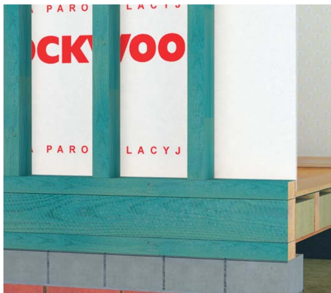
WIZ. 122.1. Szkielet drewniany ściany z zamocowaną od wewnątrz paroizolacją.
