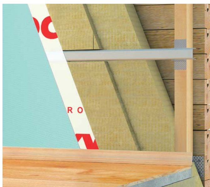
WIZ. 126.6. Wykończenie płytami gipsowo-kartonowymi.
