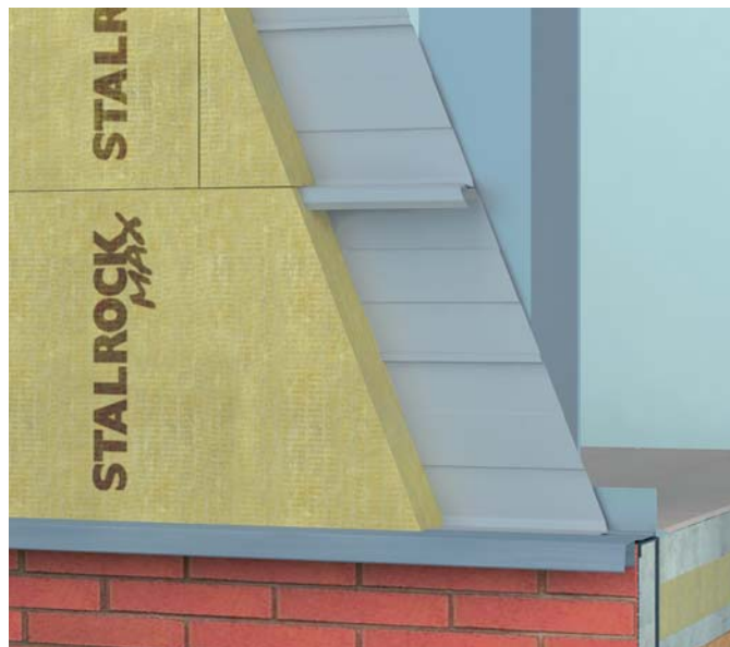
WIZ. 127.2. Ułożenie wełny STALROCK MAX na mijankę.
