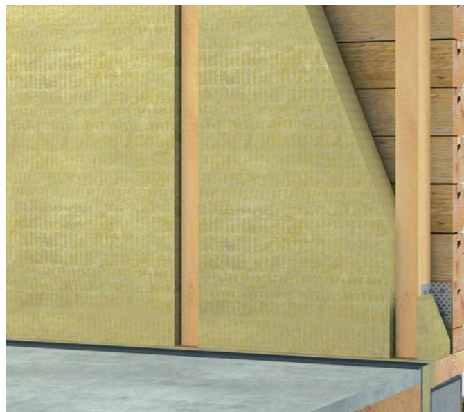
WIZ. 126.2. Ułożenie wełny między słupkami z zachowaniem pustki powietrznej między ociepleniem i balami.
