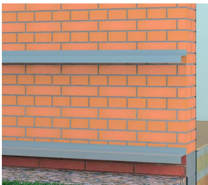
WIZ. 124.1. Mocowanie profili zetowych.
