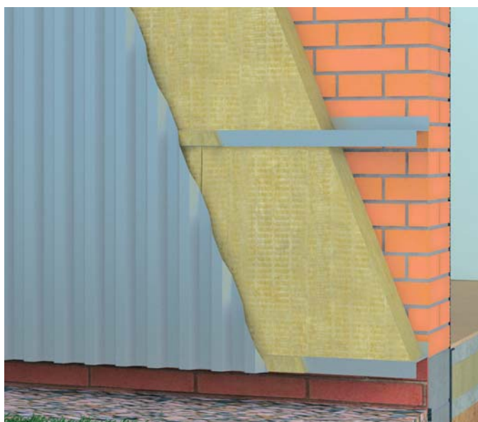
WIZ. 124.3. Przykręcanie blachy elewacyjnej.
