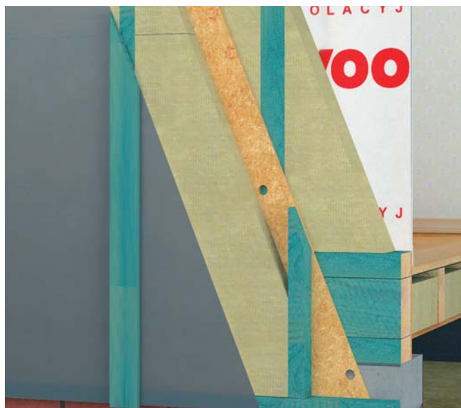
WIZ. 122.5. Zamocowanie wiatroizolacji i szerszych desek do rusztu.
